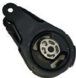
ÍTEM: CI-188 PLANO Nº: : 1806A0 MODELO: SOPORTE MOTOR INFERIOR ADAPT. C4/ C4 LOUNGE/ C4 PICASSO/ DS4/DS5- 1.8 16V/2.0 16V NAFTA EW10A
